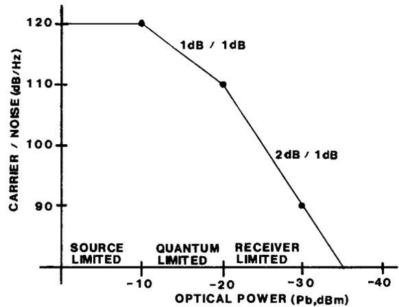
**CARRIER/NOISE VERSUS RECEIVED OPTICAL POWER**
