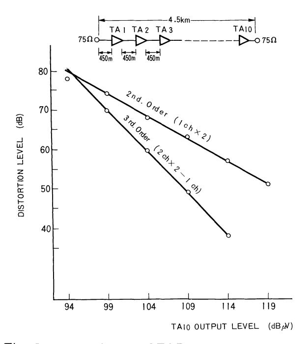
Fig. 7 <u>MEASURED DISTORTION</u>
