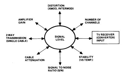
CABLE SYSTEM SIGNAL LEVEL-CABLE SYSTEM PERFORMANCE PARAMETERS
