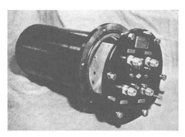
Photo. 10 UNDERGROUNDED TYPE TRUNK BRIDGE AMPLIFIER
