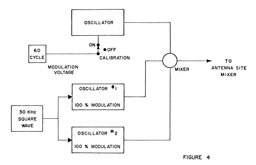
TRANSMITTER FOR CATV DISTRIBUTION TEST SET
