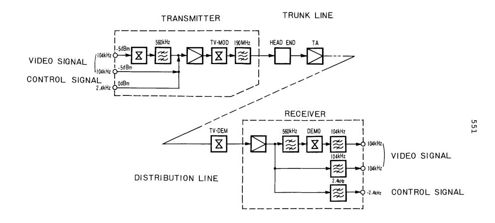
Fig. 5 <u>CATV-FACSIMILE TRANSMISSION SYSTEM</u> <u>CONFIGURATION</u>
