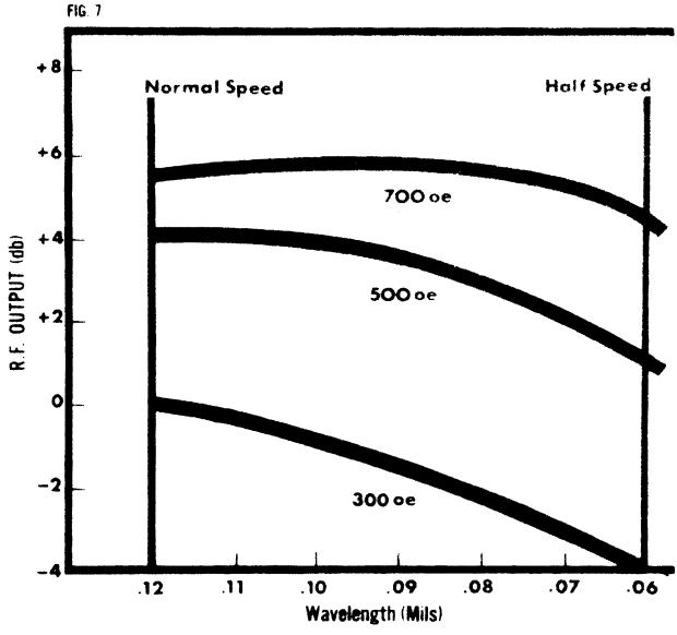
R.F. OUTPUT VERSUS WAVELENGTH OPERATING AT 2 SPEEDS
